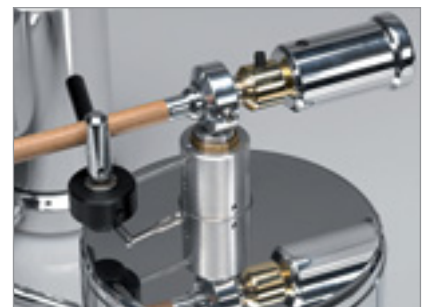
Dreh- und Angelpunkt des WTB 313: ein hochpräzises kardanisches Lager
