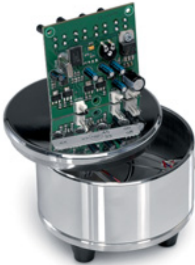
Der Berger-Motor mit eigenem Netzteil und Geschwindigkeitswahl per Schalter
