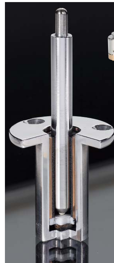
Lagerarbeit: Die Achse steckt in einer per Verguss hergestellten Kunststoffbuchse, vertikal fängt eine Keramikkugel die Kräfte auf
